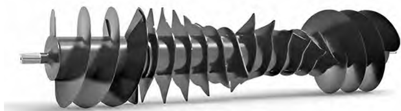
Рис. 6. Конструкція ротора Optifeed з одинарними зубцями і вбудованими шнеками забезпечує вирівнювання валка шляхом рівномірного розподілу рослинної маси, щоб кожен раз отримувати однакові тюки.
