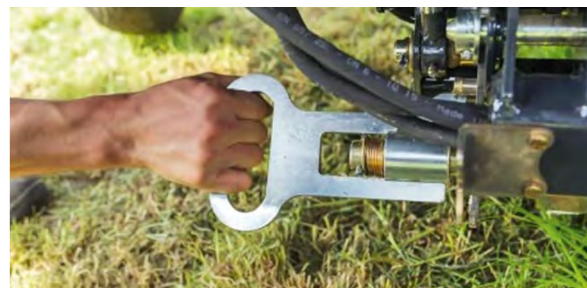
У стандартній комплектації всі ріжучі ротори мають функцію вибору групи (за винятком VB 3255–3285). Ножі можна вмикати/вимикати за допомогою пульта керування
