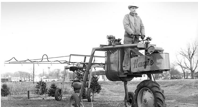
Мал. 5. У 1947 році американська компанія Hagie Manufacturing представила перший у світі самохідний обприскувач для комерційного використання — Hagie Model 76.
