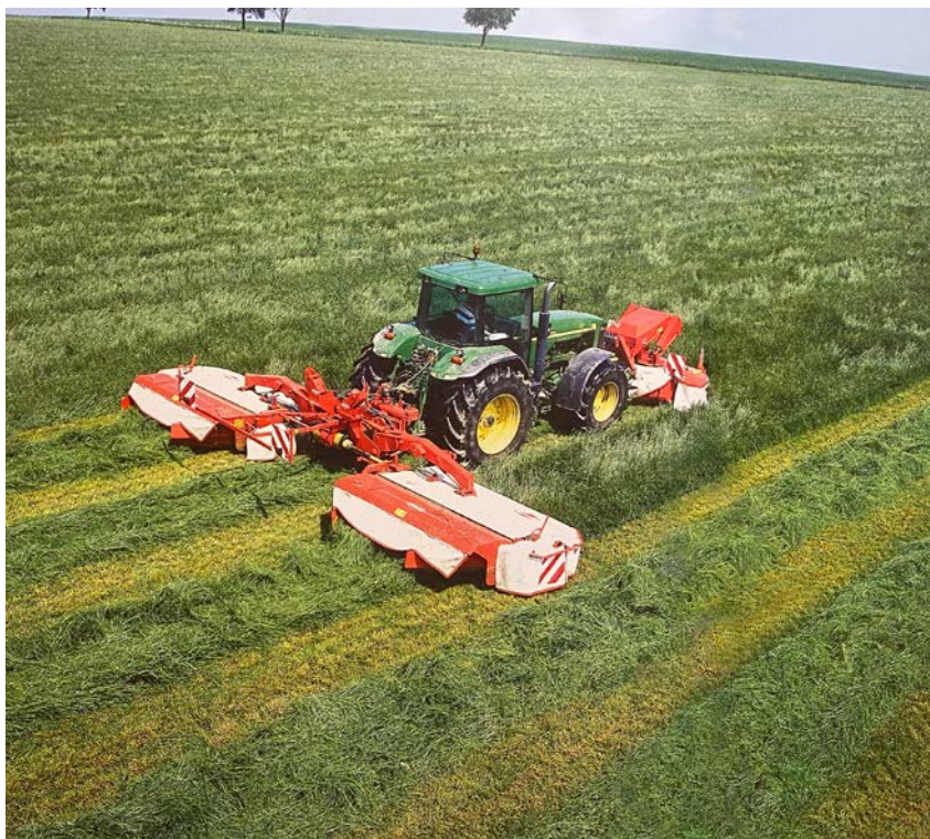
Комбінація потрійної косарки-плющилки FC, що складається з фронтального навішування FC 313 F та заднього навішування FC 883 (ширина скошування 8,8 метрів).
