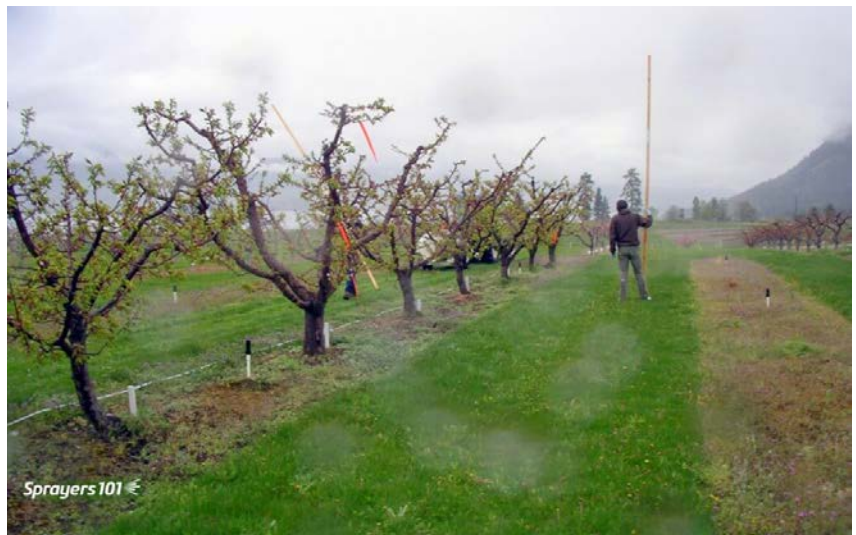
Малюнок 4. Дослідження дрейфу вентиляторного обприскувача за допомогою стрічок і довгої вертикальної жердини з водочутливими папірцями, прикріпленими степлером. Дослідження робили виключно з використанням води, щоб не нашкодити людині, яка тримала жердину. Джерело фото: М. Уорінг, Британська Колумбія.
